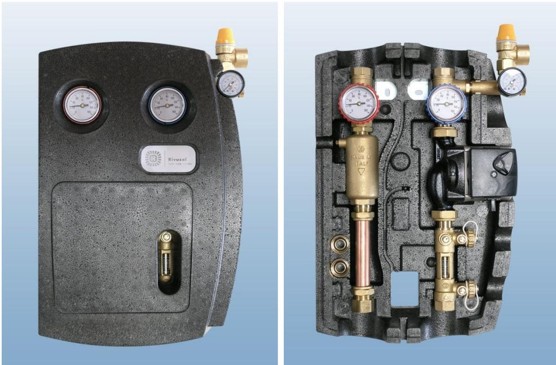
***Isolierte Pumpenstation für Vorlauf- und Rücklaufleitungen des Solarkreises, inklusive Pumpe. Einstellbarer Volumenstrom, Durchflussmesser und Thermometer, Permanententlüfter***
